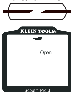
CABLE COAXIAL EN CIRCUITO ABIERTO:
